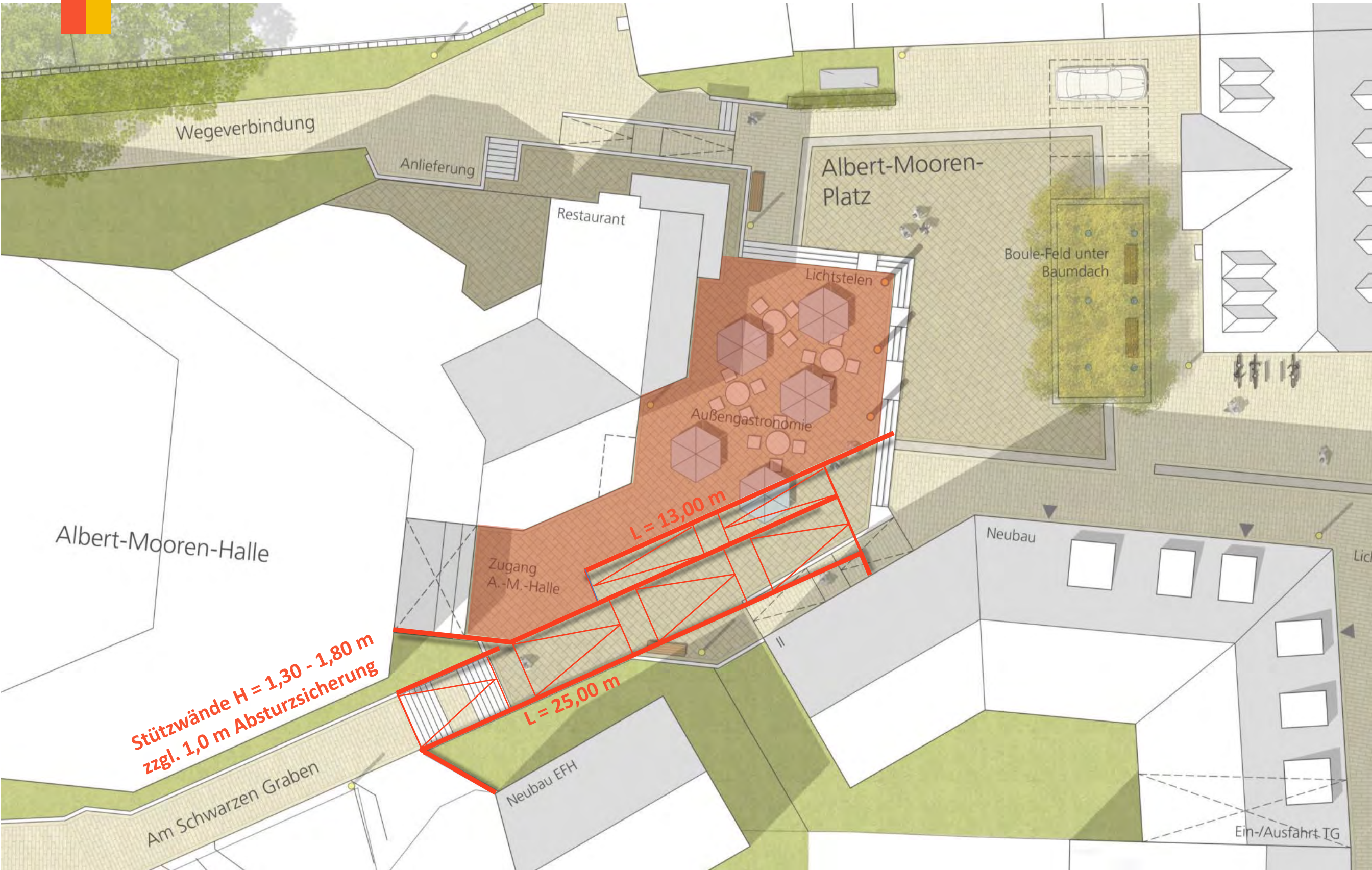
Barrierefreiheit - Rampenlösung für südliche Wegeverbindung
